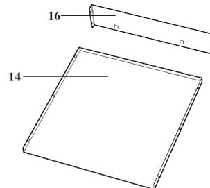
Montieren Sie die Seitenwände mit deren Abkantungen nach Außen.
