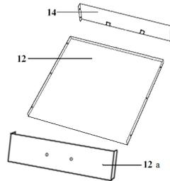
Die Seitenwände mit den Abkantungen nach außen einstecken. Den Boden und die Seitenwände verschrauben. Darauf achten, dass die Schraubenköpfe von außen zu sehen sind.
