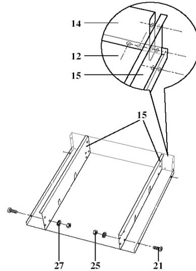
Blenden so montieren, dass die größere Biegung sich oben befinden. Die Blende umschließt die Schublade und gibt dem Boden halt.
